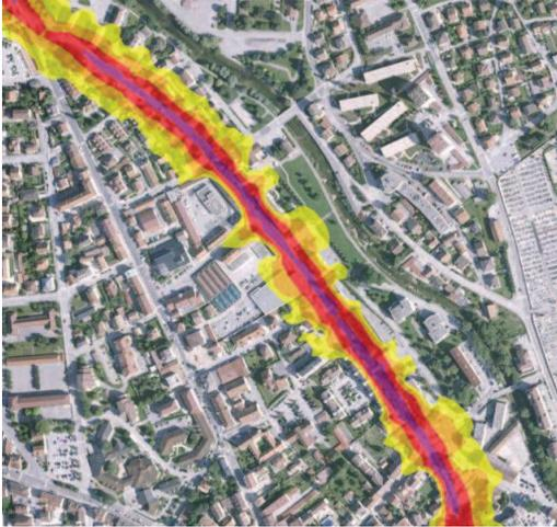
**Les cartes de type A** ou cartes des niveaux d'exposition au bruit font apparaître par pas de 5 dB(A) les zones exposées à plus de 55 dB(A) en  $L_{den}$  et 50 dB(A) en  $L_n$ .
